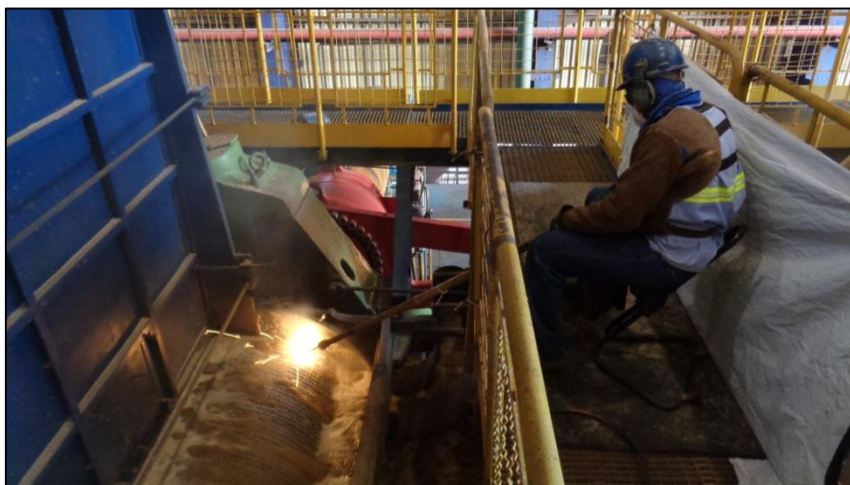
Figura 20 – Chapisco de rolo de moenda (rolo inferior de saída)
